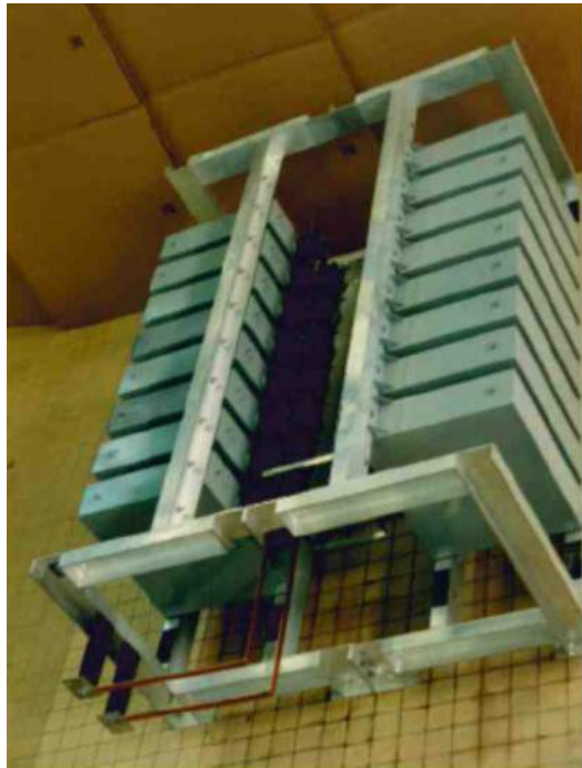
TFL 118 : 160\mu\text{F} \pm 10\% - 32kV – 1250kg
