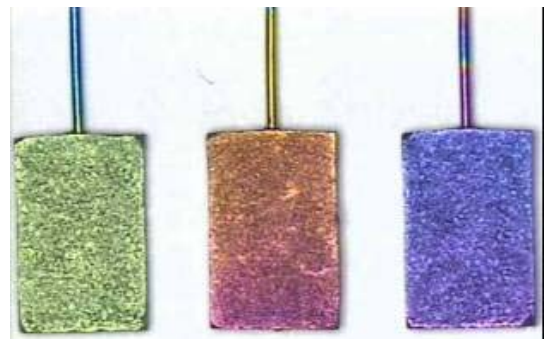
图 5. [绿色] - 非-壳成型电极 (104 V); [红] - 传统壳成型电极 (125-130 V); [蓝色] - 种壳成型电极 (140 V)
