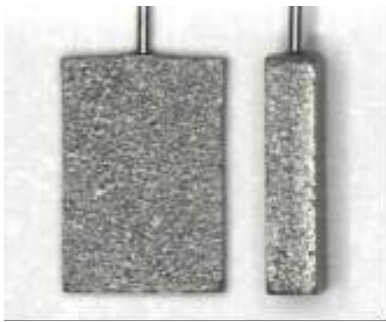
图 4. 烧结后电极芯体的合格形态
