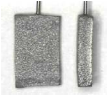
图 3. 烧结后不合格的电极形态
